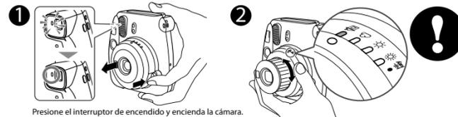
Presione el interruptor de encendido y encienda la cámara. El piloto de aviso de carga del flash situado a la izquierda del ocular comienza a parpadear. (Indica que el flash se está cargando.) No podrá tomar ninguna fotografía mientras el piloto está parpadeando.
